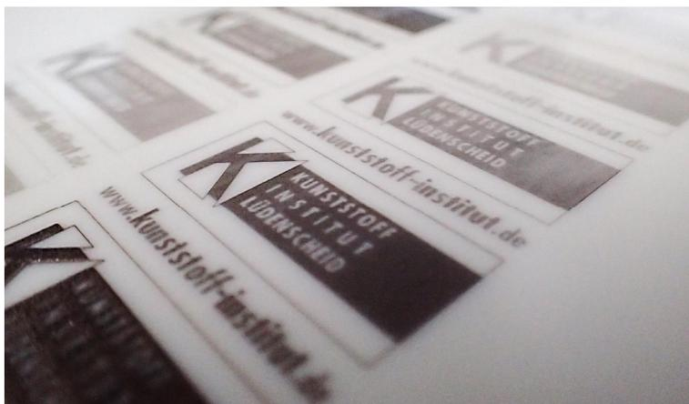
Intensitätsänderung der Grau-Töne bei hellem Thermoplast. Hier durch unterschiedliche Verfahrensgeschwindigkeiten
